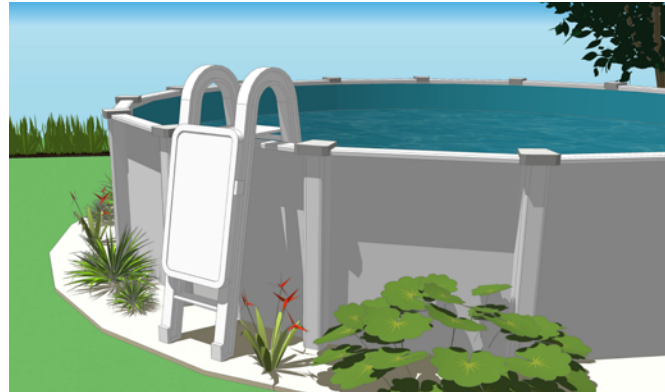
Exemple d'échelle munie d'une portière de sécurité.
