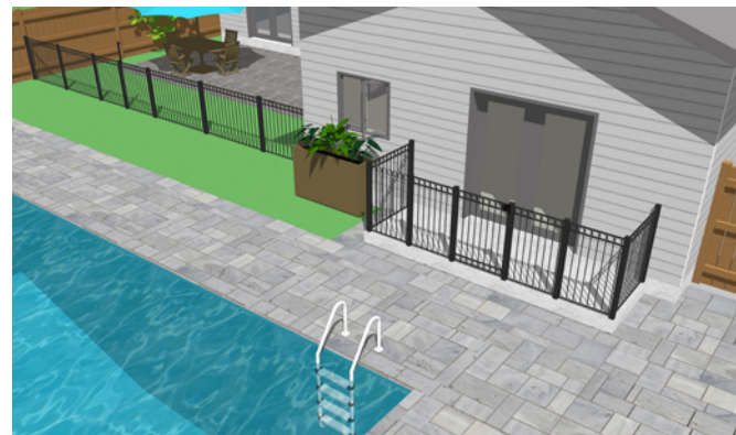
Porte-patio entourée d'une clôture afin d'empêcher l'accès direct à l'intérieur de l'enceinte de la piscine.
